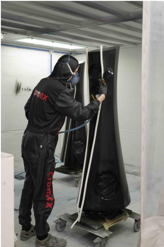
Forza の塗装作業
