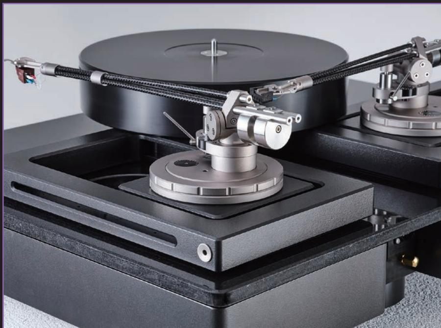
アウトタープラッターと同様の超硬質ボールの組み合わせによるデカップリング方式を適用しました。ボード側に3個の小型ボール状突起を配置、シャーシ側に大型可動ボール1個を配置することで、接触面積を最小化しています。
